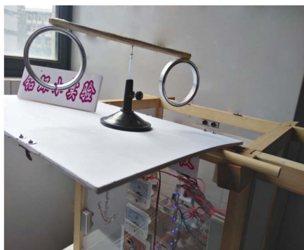
图 6 铝环实验装置图
